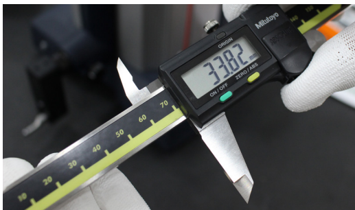
① 기본적으로 디지털 캘리퍼스는 원점 0에서부터 슬라이더를 당기면 측정 수치가 액정에 표시되게 됩니다. 이것을 엡솔루트 방식(ABS), 절대측정 방식이라 부릅니다. 상기 사진에서는 33.82mm를 표시하고 있는 것을 확인할 수 있습니다.
