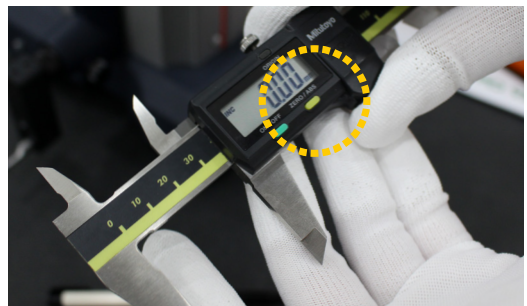
② 여기서 액정 주변의 ZERO/ABS 버튼을 누르게 되면 비교측정 방식으로 전환되며 현재 슬라이더의 위치를 0으로 삼아 이 위치를 기준으로 측정된 수치가 액정에 표시됩니다.
